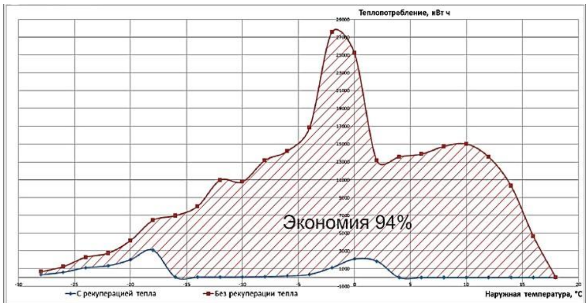
Рис. 18. Испытания системы рекуперации на свиномкомплексе «Хвалынский» Саратовской области
