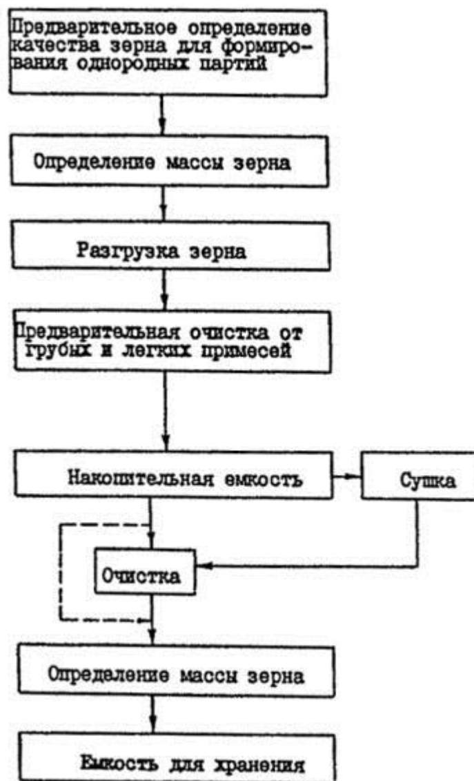
Рис. 2. Принципиальная схема процесса приемки зерна с автотранспорта
