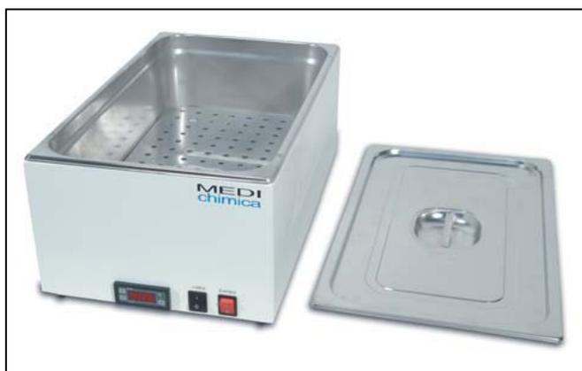
**Рис. . Водяная баня с термостатом фирмы Medichemica (Италия)**
