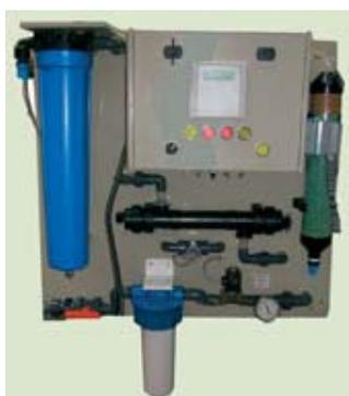
**Рис.32.** Деионизатор с УФ облучателем.
