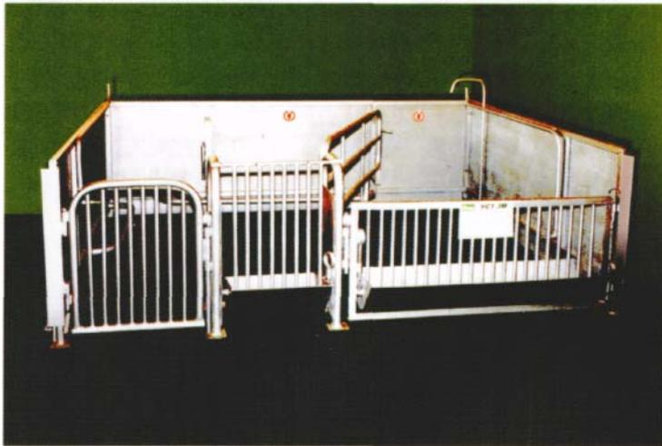
Ограждение для содержания и кормления свиноматки с поросятами УСТ-3М представляет собой бокс, ограниченный с трех сторон кирпичными стенками, а со стороны кормовозного прохода – технологичными металлоконструкциями. Внутри бокса имеется перегородка, сделанная в виде поворотной диагонали, которая имеет два положения в зависимости от времени содержания свиноматки и возраста поросят.
