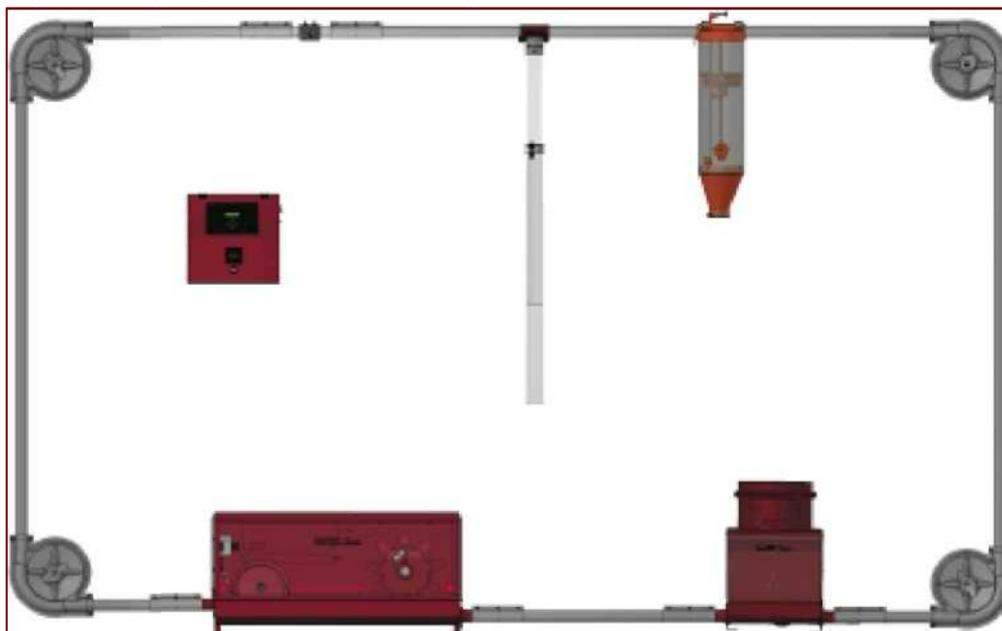
**Рис. Принципиальная схема работы системы кормораздачи**
