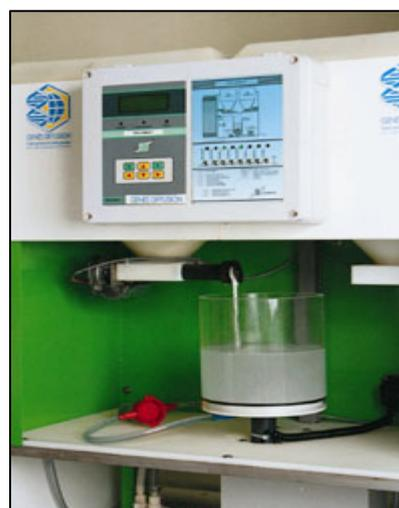
**Рис. .** *Аппарат для приготовления разбавителя и разбавления спермы 1л\мин. Производитель Genes Diffusion (Франция)*
