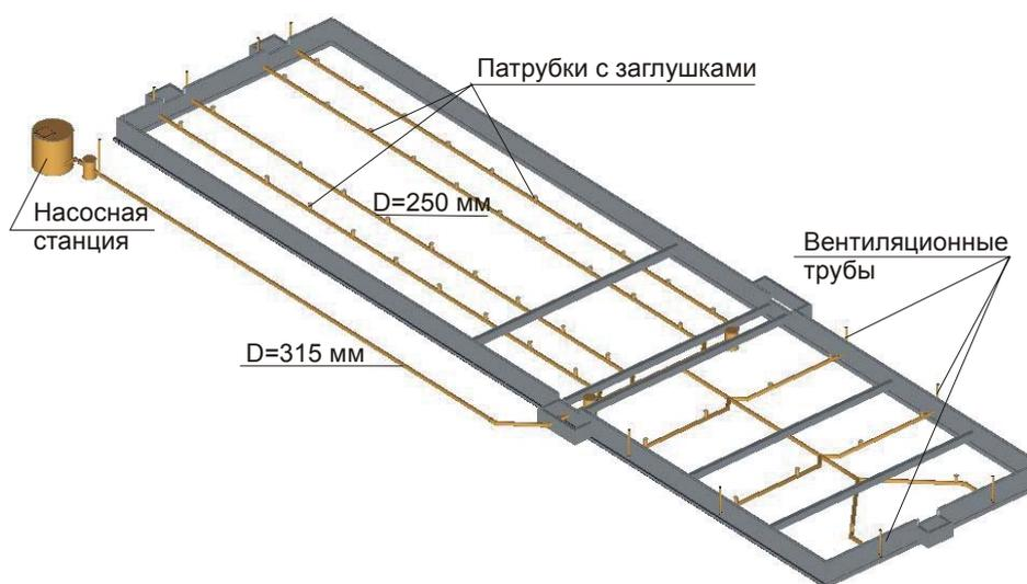
**Рис. Устройство сборных коллекторов**
