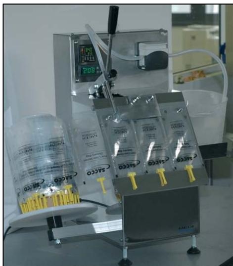
**Рис. . Ручная машина с перистальтическим насосом по розливу спермы в индивидуальные пакетики Med-chetisa (Италия)**
