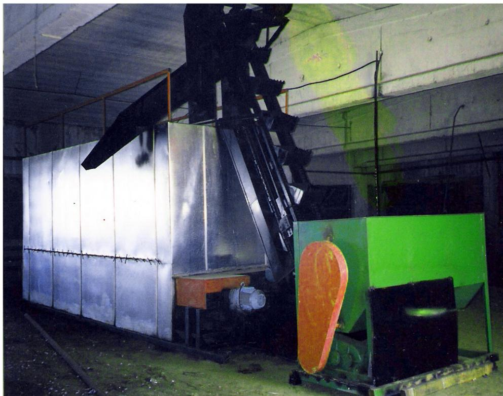
**Рис. 1а. Установка экспресс-компостирования УЭК-5**
