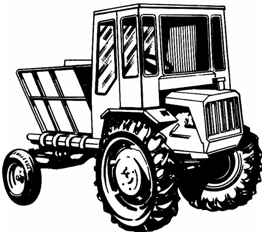
*Рис. Раздатчик кормов Т-16МТ на базе самоходного шасси*
