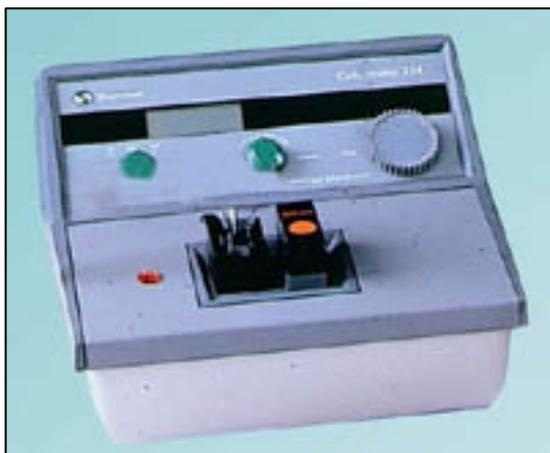
**Рис.19.** Фотометр CIBA-Corning 254 со специальным светофильтром 540 для исследования спермы хряков
